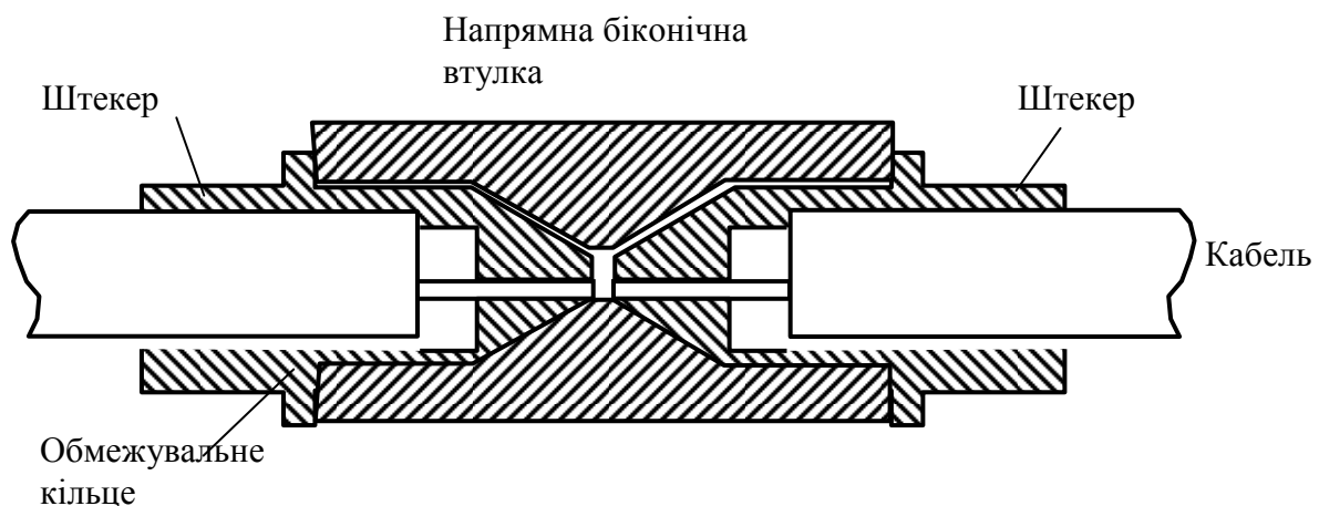
Рисунок 2.4 – Розріз конструкції з'єднувача з конічною втулкою
