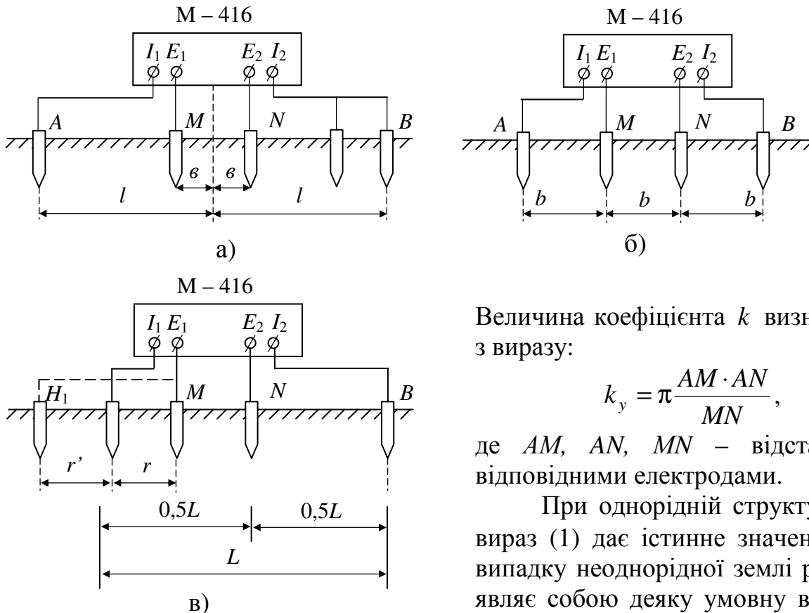
Рисунок 2.2 – Схема для ВЕЗ з вимірювачем заземлень М – 416: а – Шлюмберже, б – Веннера, в – ВНДІЕСХ
