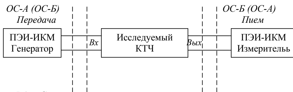
Рис. 5.1 – Схема измерения остаточного затухания, амплитудно-частотной характеристики, шумов квантования и шума незанятого КТЧ
