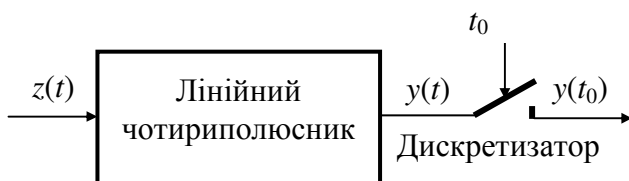
Рисунок 4.1 – Увімкнення чотириполіусника і дискретизатора
