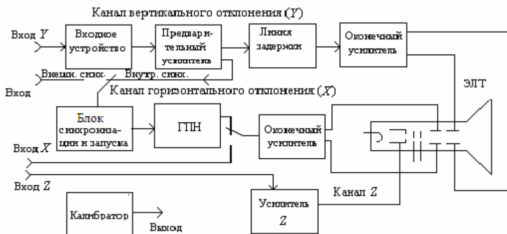
Рисунок 2.1 – Структурная схема универсального осциллографа
