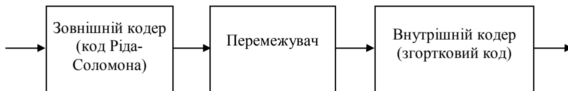
Рисунок 13.4 – Структурна схема кодера послідовного каскадного коду
